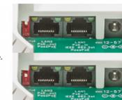
Допускается подключать нагрузку на LAN2 с постоянным потреблением тока 1А и кратковременно 1.5А.
